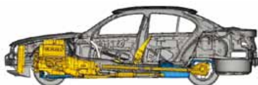
悬架系统的轮辋最上部撞上防护栏的碰撞分析结果
